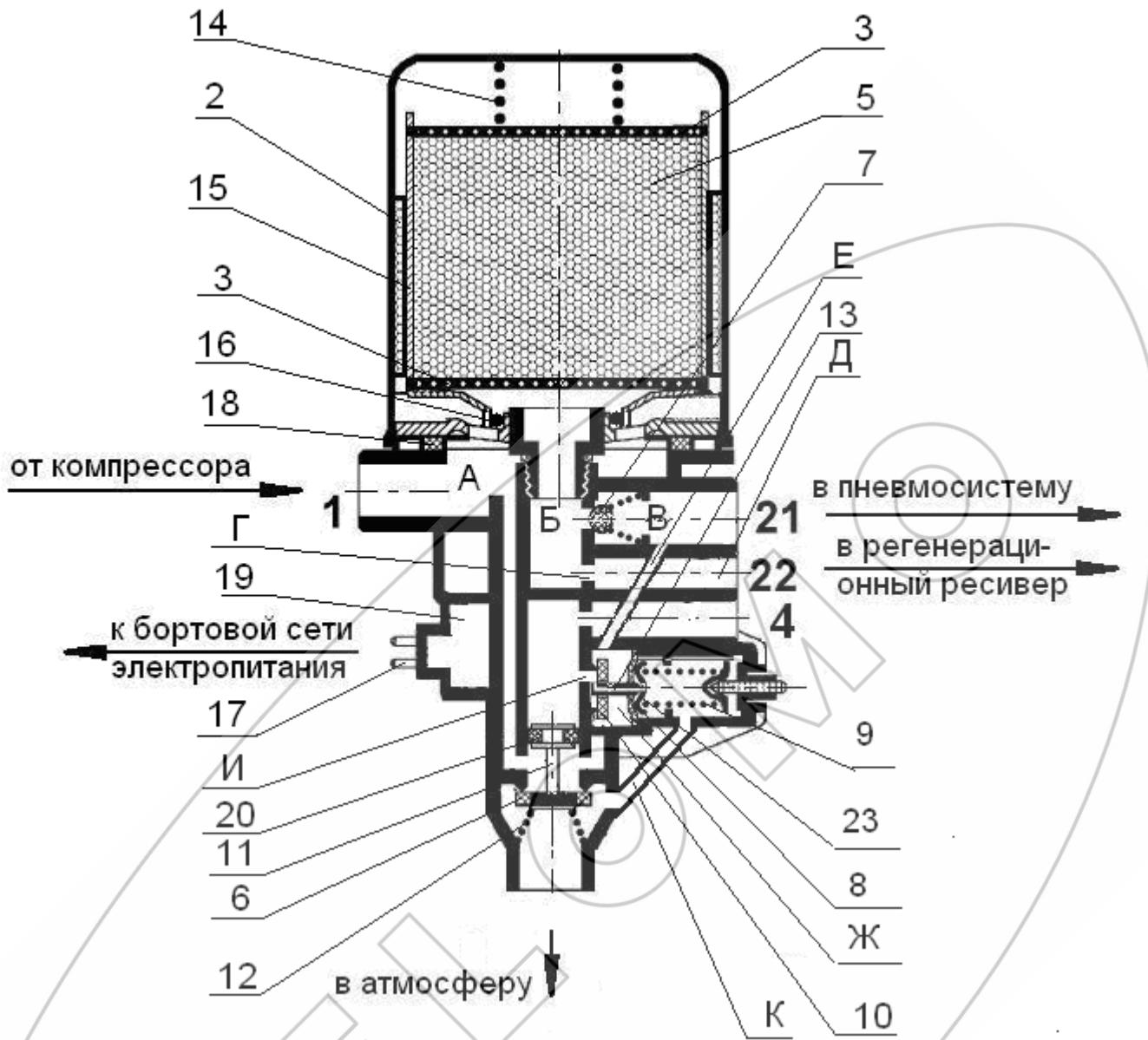
1, 21, 22, 4 – вывод; 2, 3 – фильтр; 5 – цеолитовый адсорбер; 6 – предохранительный клапан; 7 – обратный клапан; 8 – манжета; 9, 12, 14 – пружина; 10 – клапан; 11 – поршень; 13 – золотник; 15 – стакан; 16, 18 – уплотнение; 17 – вилка подключения блока нагрева к бортовой сети электропитания АТС; 19 – блок нагрева; 20 – уплотнительное кольцо; 23 – тарелка, А, Б, В, Д, Ж – полость; Г, Е, И – канал; К – дренажное отверстие
