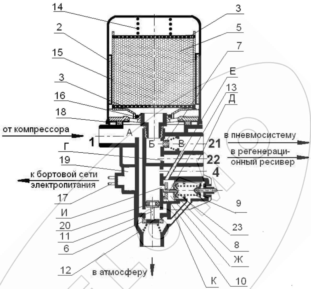
1, 21, 22, 4 – вывод; 2, 3 – фильтр; 5 – цеолитовый адсорбер; 6 – предохранительный клапан; 7 – обратный клапан; 8 – манжета; 9, 12, 14 – пружина; 10 – клапан; 11 – поршень; 13 – золотник; 15 – стакан; 16, 18 – уплотнение; 17 – вилка подключения блока нагрева к бортовой сети электропитания АТС; 19 – блок нагрева; 20 – кольцо; 23 – тарелка, А, Б, В, Д, Ж – полость; Г, Е, И – канал; К – атмосферное отверстие
