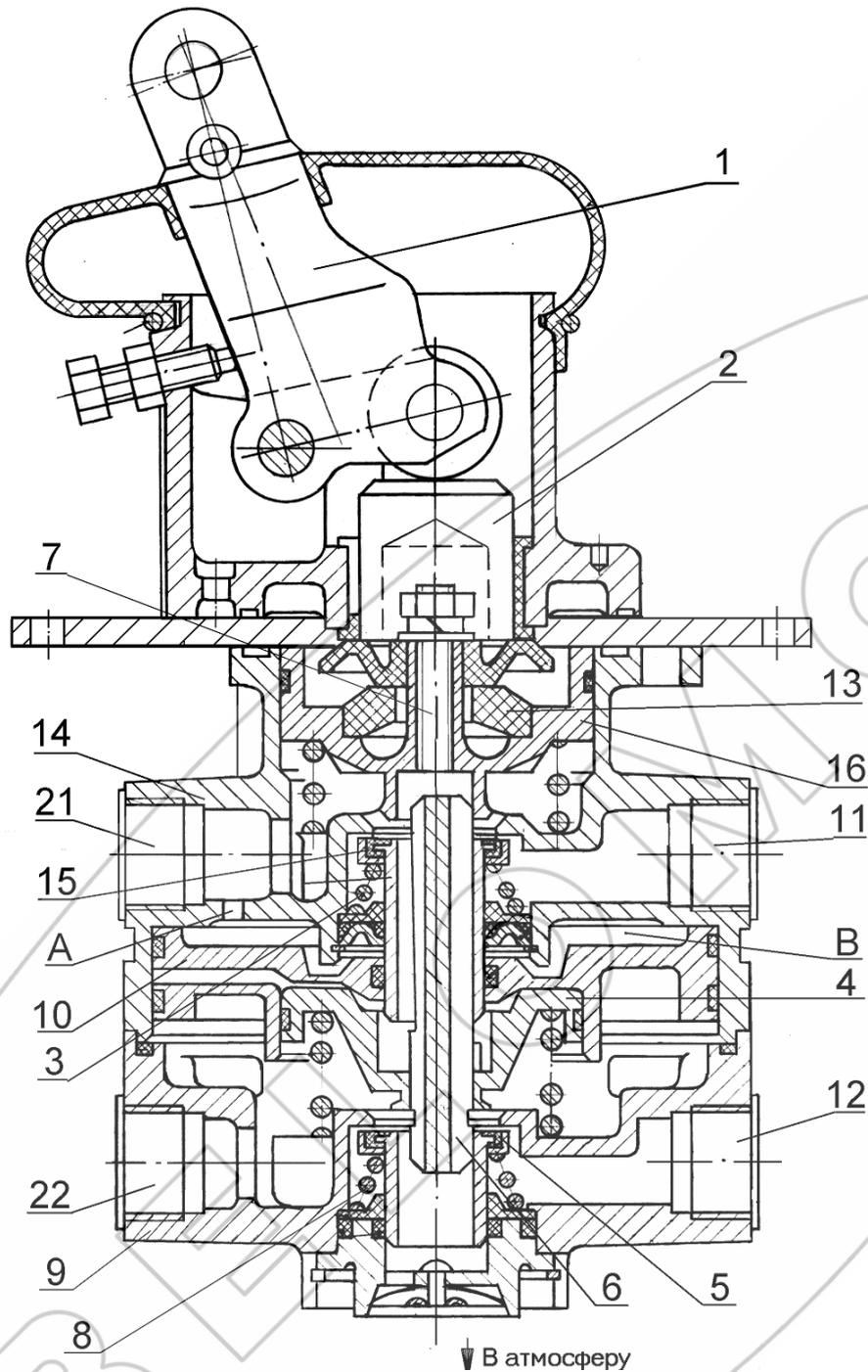
1-рычаг; 2-толкатель; 3,8 - пружина клапана; 4,16- поршень следящий; 5,15-клапан; 6-шток полый; 7-шпилька; 9-корпус нижний; 10-поршень; 11,12-ввод; 13- элемент уравнивающий; 14-корпус верхний;; 21,22-вывод.
