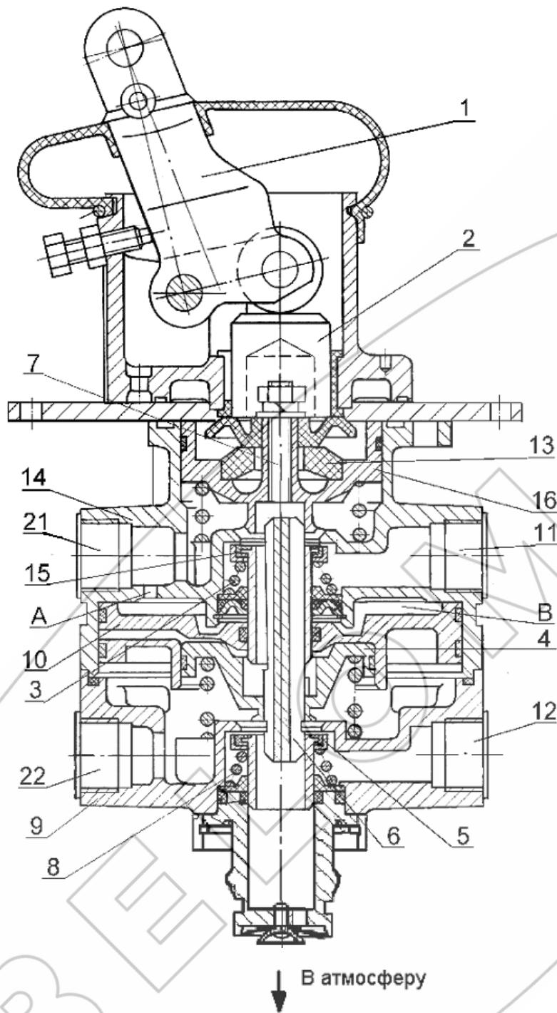
1-рычаг; 2-толкатель; 3,8 - пружина клапана; 4,16- поршень следящий; 5,15-клапан; 6-шток полый; 7-шпилька; 9-корпус нижний; 10-поршень; 11,12-ввод; 13- элемент уравновешивающий; 14-корпус верхний;; 21,22-вывод.
