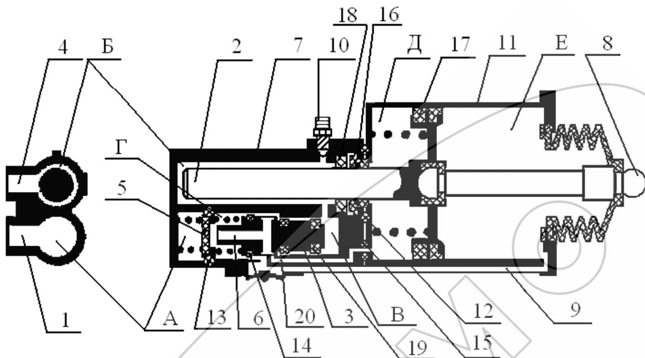
1 – ввод сжатого воздуха; 2 – поршень; 3 – следящий поршень; 4 – ввод тормозной жидкости; 5 – воздушный клапан; 6 – выпускное отверстие поршня; 7, 11 – корпуса; 8 – шток; 9 – трубка; 10 – клапан перепускной; 12, 13, 14, 15, 16 – кольца уплотнительные; 17, 18, 19 – манжеты; 20 – канал воздушный; А, Б, В, Г, Д, Е – полости усилителя.
