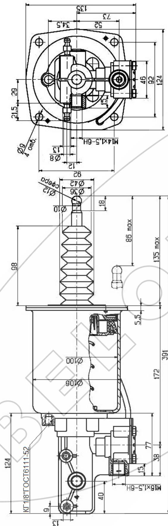
Рисунок 1 – Габаритные и присоединительные размеры усилителя
