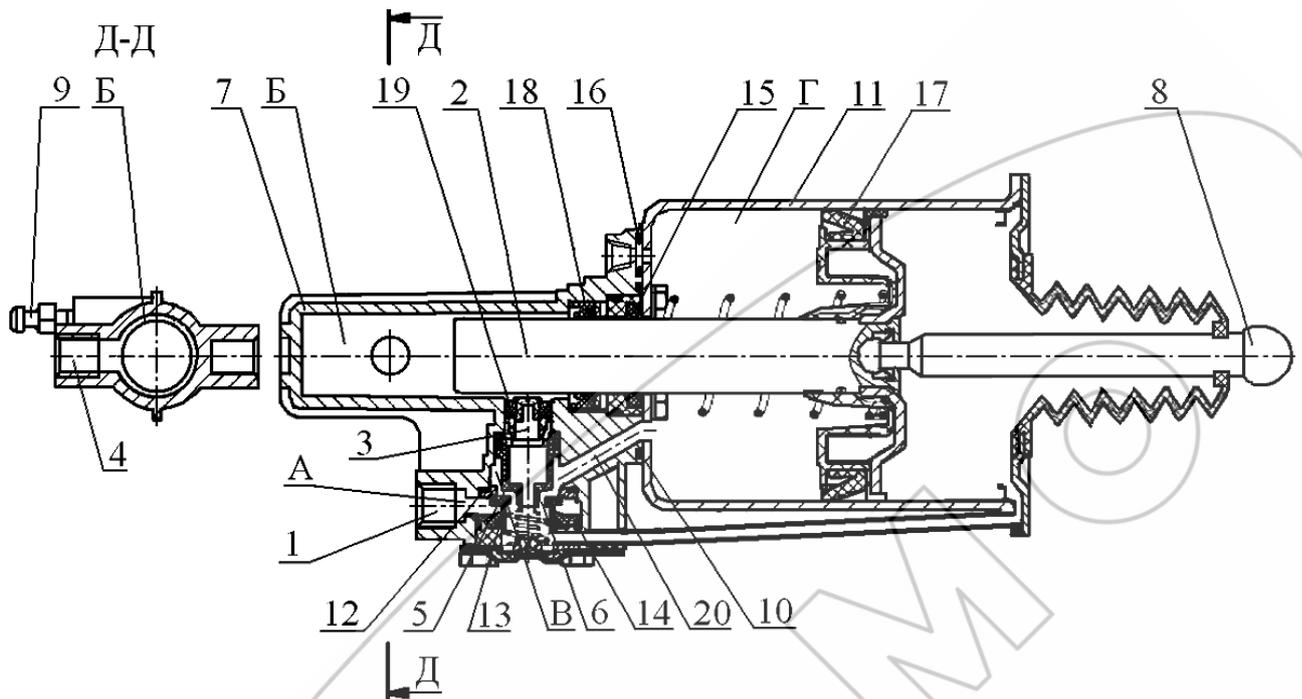
1 – ввод сжатого воздуха; 2 – поршень; 3 – следящий поршень; 4 – ввод тормозной жидкости; 5 – воздушный клапан; 6 – выпускное отверстие воздушного клапана; 7, 11 – корпус; 8 - шток; 9 – клапан перепускной; 10, 12, 13, 14, 15, 16 – кольцо уплотнительное; 17, 18, 19 – манжета; 20 – канал воздушный; А, Б, В, Г – полость усилителя.
