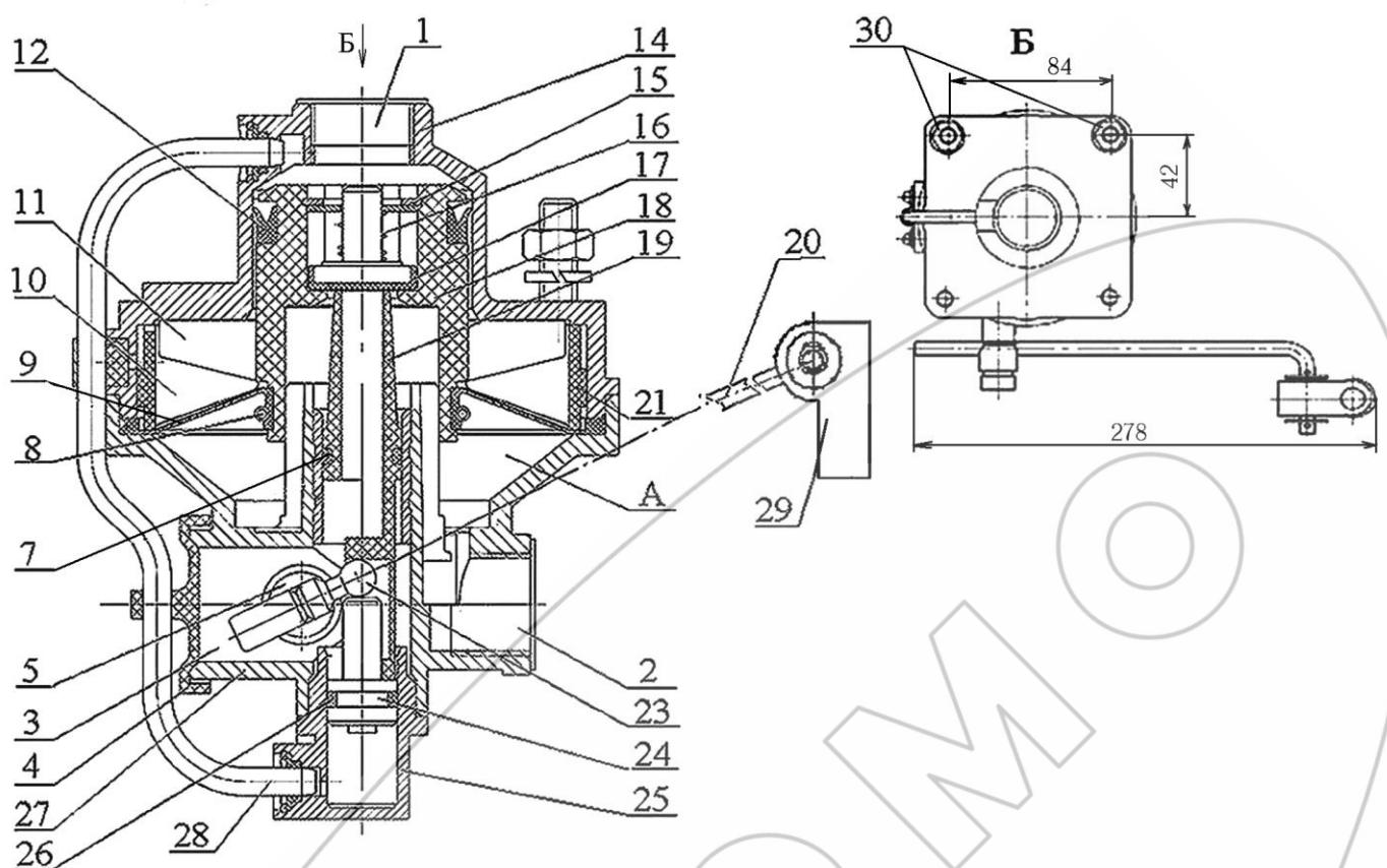
1 – подвод от тормозного крана; 2 – вывод к тормозным камерам; 3 – атмосферный вывод; 4, 17 – клапан; 5 – вал; 15 – упорное кольцо; 7, 26 – уплотнительное кольцо; 8 – пружина; 9 – диафрагма; 10 – ребра вставки; 11 – ребра поршня; 12 – манжета; 14 – верхний корпус; 16 – пружина; 18, 24 – поршни; 19 – толкатель; 20 – рычаг; 21 – вставка; 23 – шаровая пята; 25 – направляющий колпачок; 27 – нижний корпус; 28 – трубка; 29 – муфта; 30 – монтажный болт.
