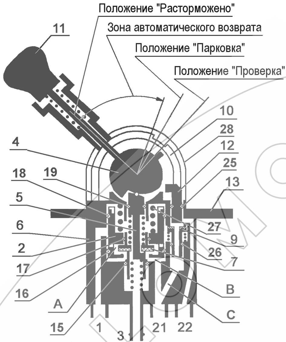
1, 21, 22 – подвод, 2 – поршень, 3 – вывод в атмосферу, 4 – кулачок, 5 – толкатель, 6, 10 – корпус, 7, 9 – клапан, 11 – рукоятка, 12 – толкатель, 13 – плита, 15, 16, 17, 18, 19, 25, 26 – кольцо уплотнительное, 27 – пружина, 28 – кожух, А, В – камера, С – канал;
