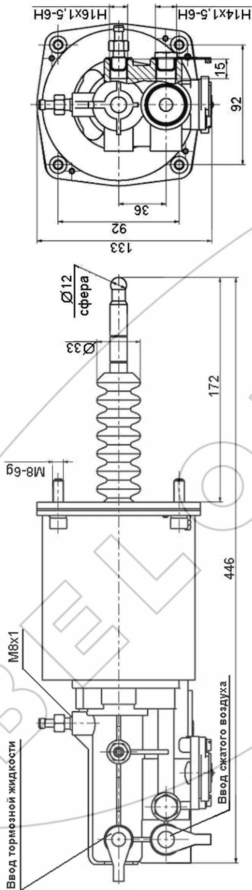
Рисунок 1 – Габаритные и присоединительные размеры усилителя
