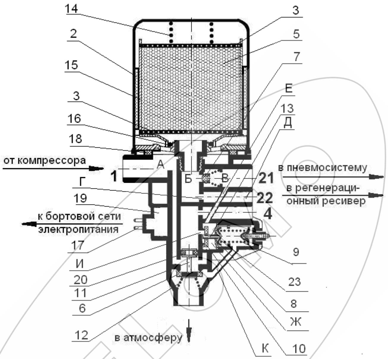
1, 21, 22, 4 – вывод; 2, 3 – фильтр; 5 – цеолитовый адсорбер; 6 – предохранительный клапан; 7 – обратный клапан; 8 – манжета; 9, 12, 14 – пружина; 10 – клапан; 11 – поршень; 13 – золотник; 15 – стакан; 16, 18 – уплотнение; 17 – вилка подключения блока нагрева к бортовой сети электропитания АТС; 19 – блок нагрева; 20 – кольцо; 23 – тарелка, А, Б, В, Д, Ж – полость; Г, Е, И – канал; К – атмосферное отверстие
