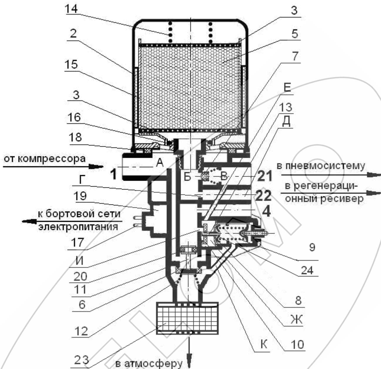
1, 21, 22, 4 – вывод; 2, 3 – фильтр; 5 – цеолитовый адсорбер; 6 – предохранительный клапан; 7 – обратный клапан; 8 – манжета; 9, 12, 14 – пружина; 10 – клапан; 11 – поршень; 13 – золотник; 15 – стакан; 16, 18 – уплотнение; 17 – вилка подключения блока нагрева к бортовой сети электропитания АТС; 19 – блок нагрева; 20 – уплотнительное кольцо; 23 – глушитель; 24 – тарелка, А, Б, В, Д, Ж – полость; Г, Е, И – канал; К – дренажное отверстие
