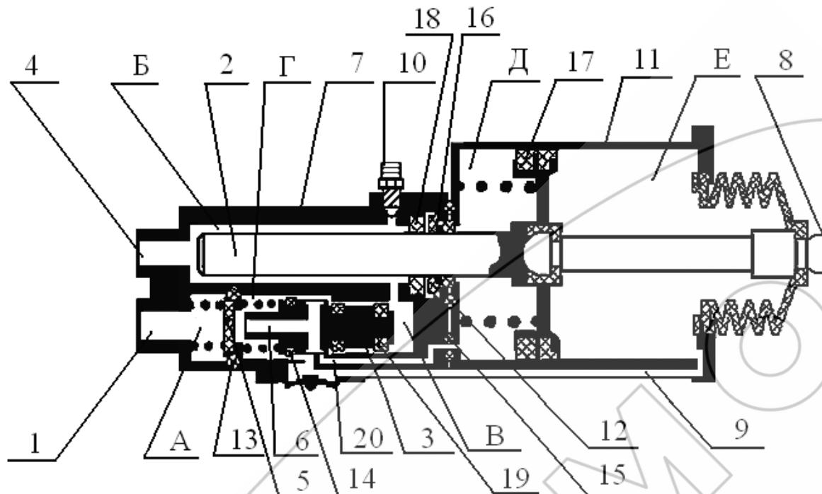
1 – ввод сжатого воздуха; 2 – поршень; 3 – следящий поршень; 4 – ввод тормозной жидкости; 5 – воздушный клапан; 6 – выпускное отверстие поршня; 7, 11 – корпуса; 8 – шток; 9 – трубка; 10 – клапан перепускной; 12, 13, 14, 15, 16 – кольца уплотнительные; 17, 18, 19 – манжеты; 20 – канал воздушный; А, Б, В, Г, Д, Е – полости усилителя.
