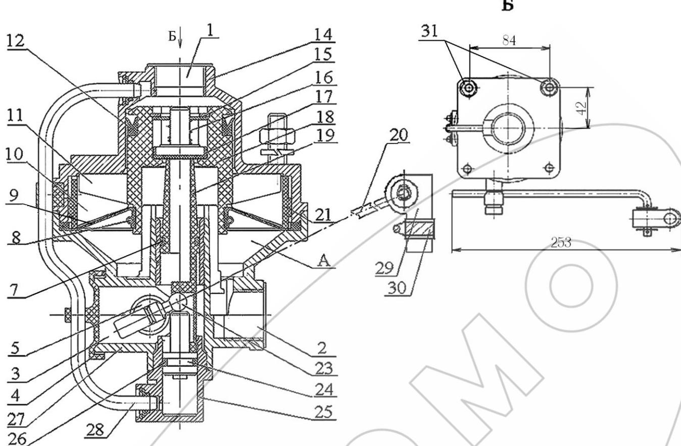
1 – подвод от тормозного крана; 2 – вывод к тормозным камерам; 3 – атмосферный вывод; 4, 17 – клапан; 5 – вал; 15 – упорное кольцо; 7, 26 – уплотнительное кольцо; 8 – пружина; 9 – диафрагма; 10 – ребра вставки; 11 – ребра поршня; 12 – манжета; 14 – верхний корпус; 16 – пружина; 18, 24 – поршни; 19 – толкатель; 20 – рычаг; 21 – вставка; 23 – шаровая пята; 25 – направляющий колпачок; 27 – нижний корпус; 28 – трубка; 29 – муфта; 30 – хомут; 31 – монтажный болт.
