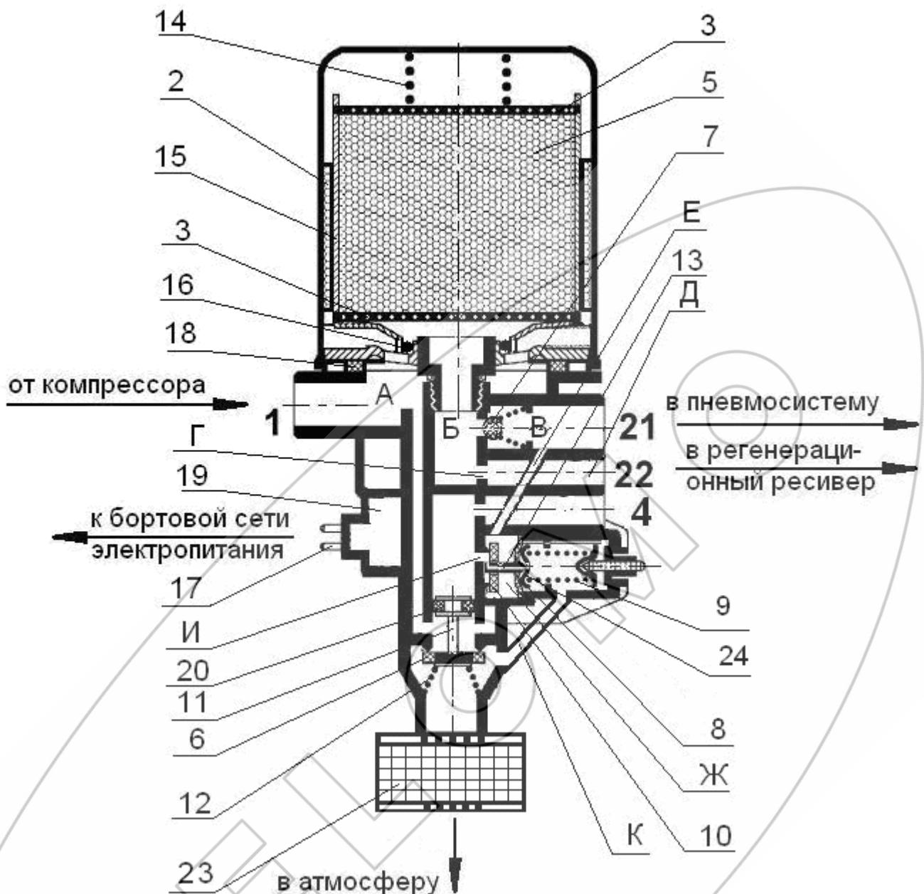
1, 21, 22, 4 – вывод; 2, 3 – фильтр; 5 – цеолитовый адсорбер; 6 – предохранительный клапан; 7 – обратный клапан; 8 – манжета; 9, 12, 14 – пружина; 10 – клапан; 11 – поршень; 13 – золотник; 15 – стакан; 16, 18 – уплотнение; 17 – вилка подключения блока нагрева к бортовой сети электропитания АТС; 19 – блок нагрева; 20 – кольцо; 23 – глушитель; 24 – тарелка; А, Б, В, Д, Ж – полость; Г, Е, И – канал; К – атмосферное отверстие
