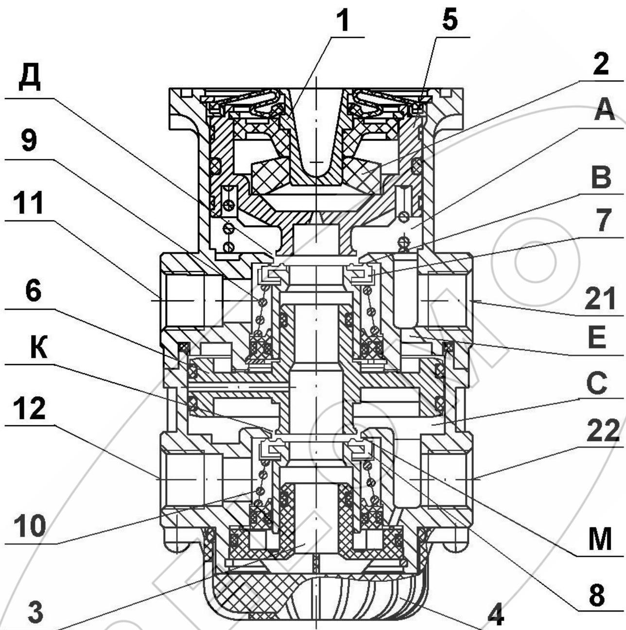
1 – толкатель, 2 – элемент уравновешивающий, 4 – глушитель, 5,6 – поршень, 7,8 – клапан, 9,10 – пружина, 11, 12 - подвод, 21, 22 – вывод, 3 – вывод в атмосферу; А, С – камеры, В,Д,Е,К,М – отверстия проходные.
