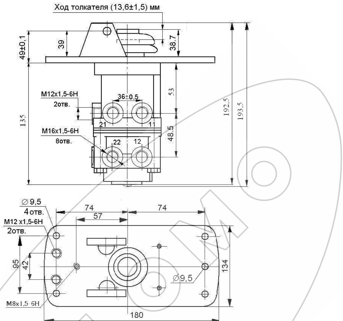
Рисунок 1 – Габаритные и присоединительные размеры крана
