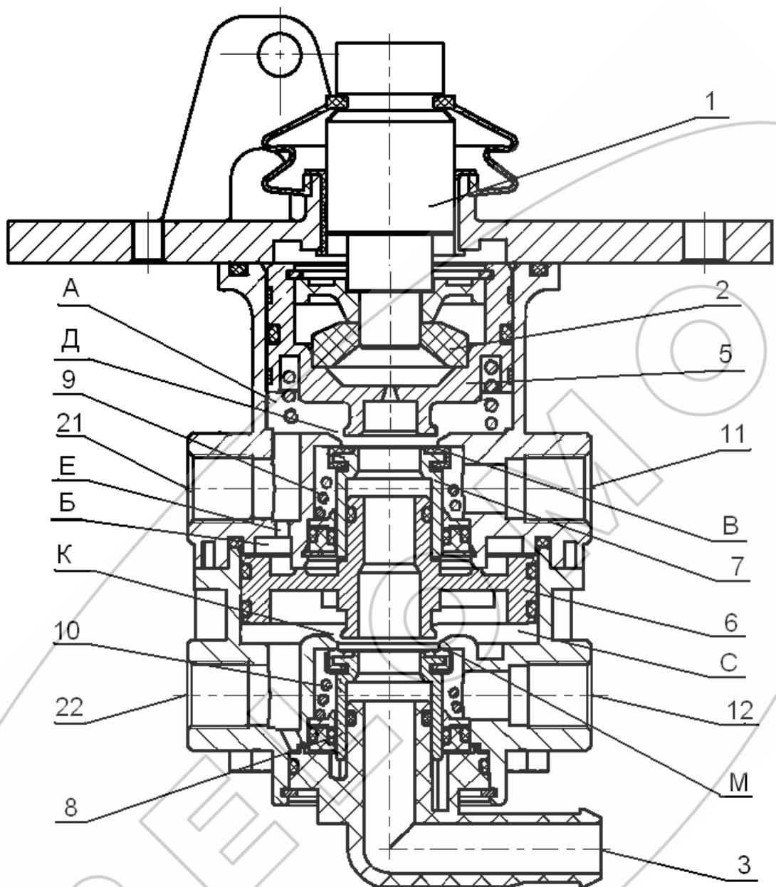
1 –толкатель, 2 –элемент уравновешивающий, 5,6– поршень, 7,8-клапан,
