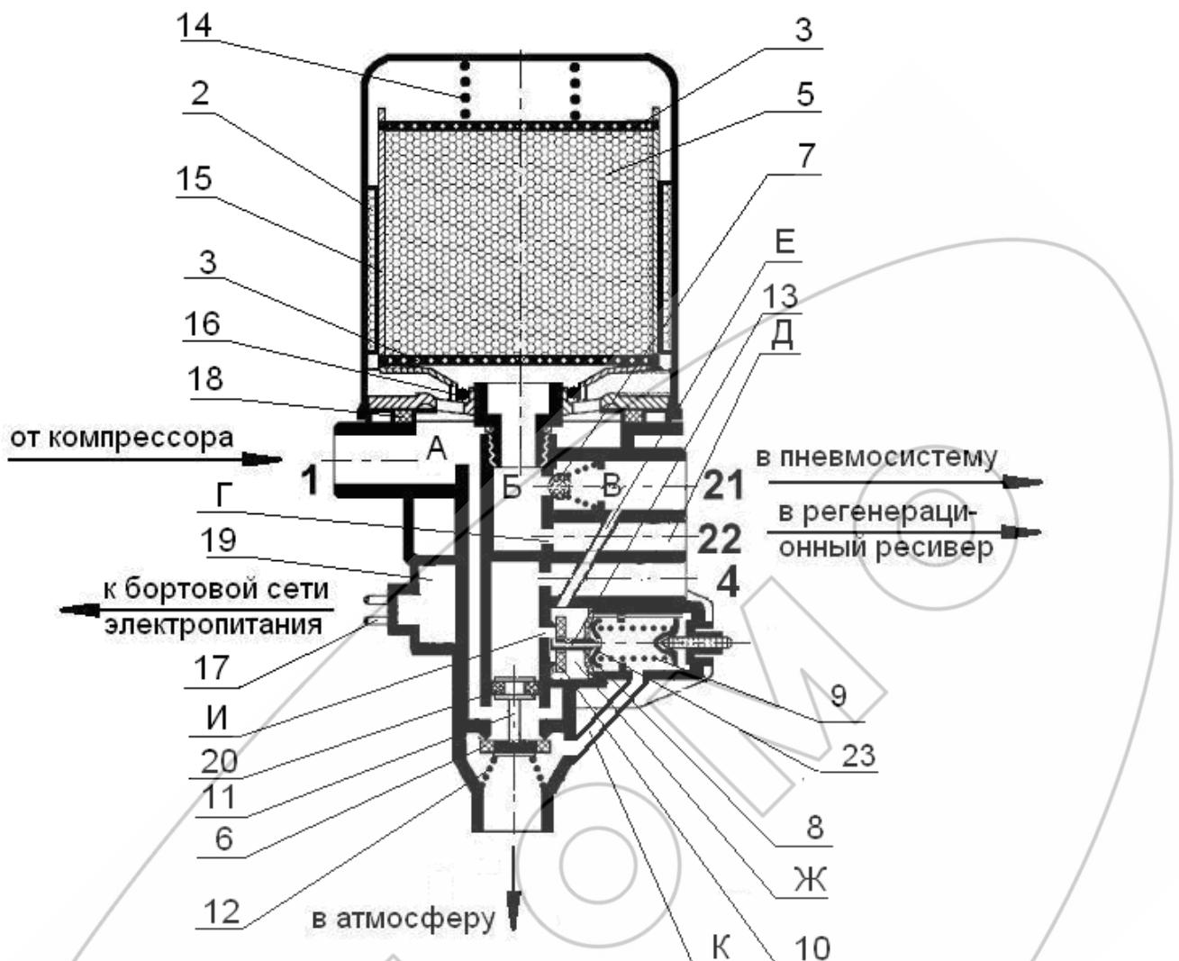
1, 21, 22, 4 – вывод; 2, 3 – фильтр; 5 – цеолитовый адсорбер; 6 – предохранительный клапан; 7 – обратный клапан; 8 – манжета; 9, 12, 14 – пружина; 10 – клапан; 11 – поршень; 13 – золотник; 15 – стакан; 16, 18 – уплотнение; 17 – вилка подключения блока нагрева к бортовой сети электропитания АТС; 19 – блок нагрева; 20 – кольцо; 23 – тарелка; А, Б, В, Д, Ж – полость; Г, Е, И – канал; К – атмосферное отверстие
