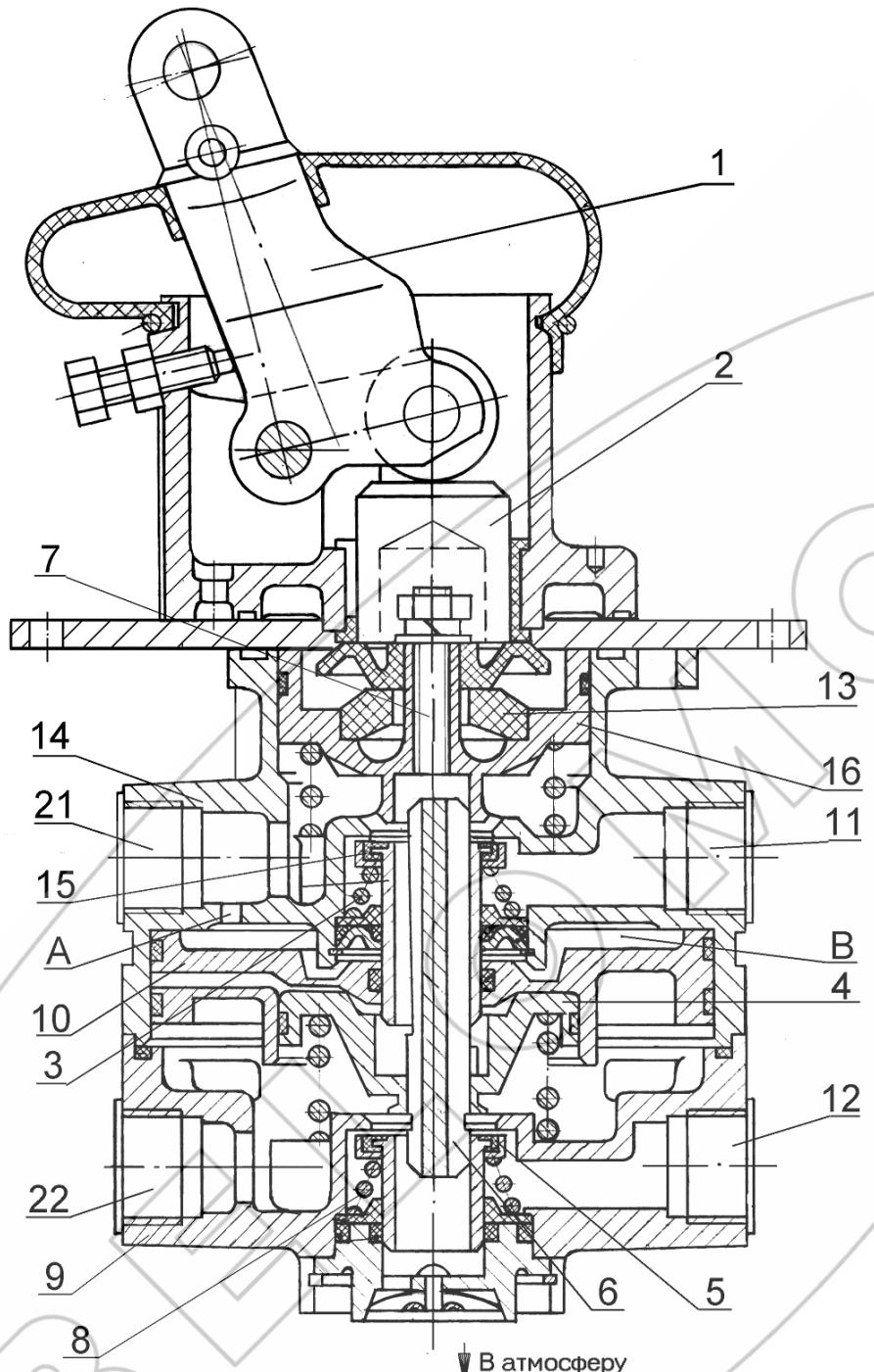
1-рычаг; 2-толкатель; 3,8 - пружина клапана; 4,16- поршень следящий; 5,15-клапан; 6-шток полый; 7-шипилька; 9-корпус нижний; 10-поршень; 11,12-ввод; 13- элемент уравновешивающий; 14-корпус верхний; 21,22-вывод.
