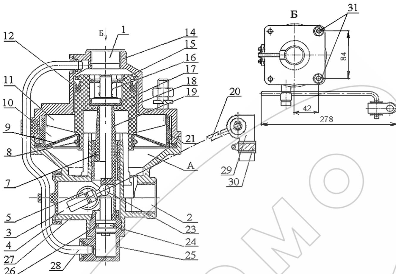
1 – подвод от тормозного крана; 2 – вывод к тормозным камерам; 3 – атмосферный вывод; 4, 17 – клапан; 5 – вал; 7, 26 – уплотнительное кольцо; 8 – пружина; 9 – диафрагма; 10 – ребра вставки; 11 – ребра поршня; 12 – манжета; 14 – верхний корпус; 15 – упорное кольцо; 16 – пружина; 18, 24 – поршень; 19 – толкатель; 20 – рычаг; 21 – вставка; 23 – шаровая пята; 25 – направляющий колпачок; 27 – нижний корпус; 28 – трубка; 29 – муфта; 30 – хомут; 31 – монтажный болт
